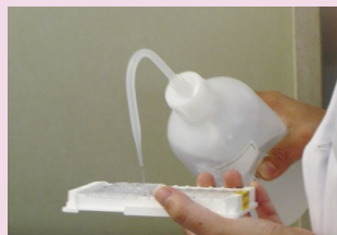
噴射ピンを用いて洗浄を行うと便利です。
